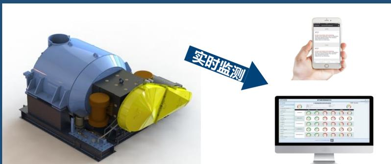
阿尔法独立开发的AI预测性维护系统和固体颗粒监测系统可实时监测离心机的核心部件的运行状态。对整机做运行故障预测，并且通过监测离心液中固体颗粒含量分析筛篮磨损情况，实时推送至电脑端、微信端。方便更换易损部件，减少设备非正常停机。
